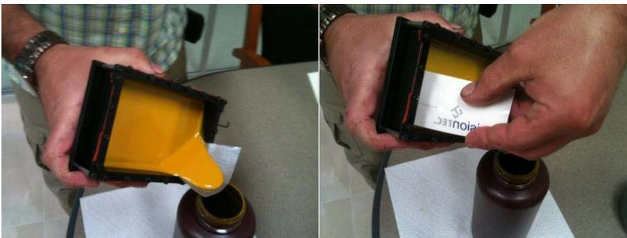
Abbildung 17: Material aus dem Basement entfernen
