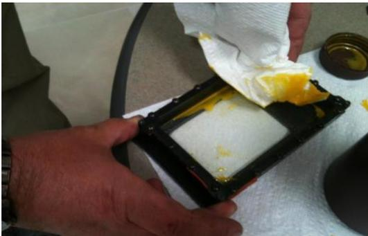
Abbildung 18: Basement reinigen
