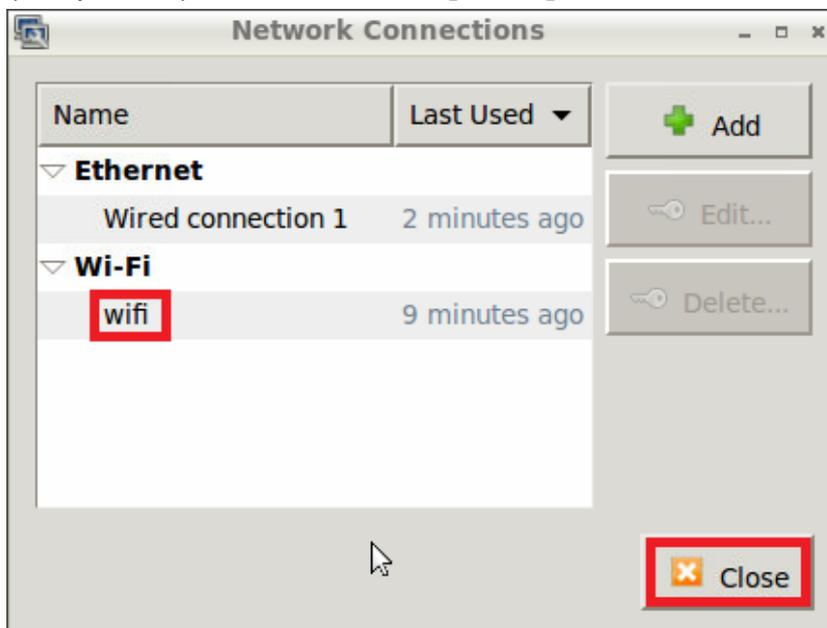
Die markierten Icons zeigen an, dass die Maschine nun über Ethernet und Wi-Fi verbunden ist.
