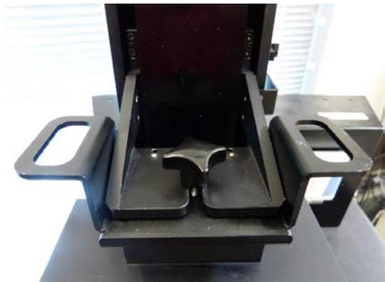
Abbildung 22: Befestigte Bauplattform
