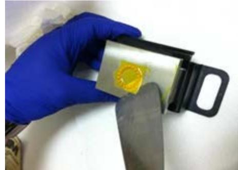
Abbildung 23: Bauteil von der Bauplattform lösen
