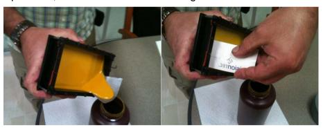
Abbildung 17: Material aus dem Basement entfernen
