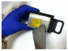
Abbildung 23: Bauteil von der Bauplattform lösen
