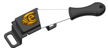
Abbildung 10: Trennen eines Modells von der Bauplattform
